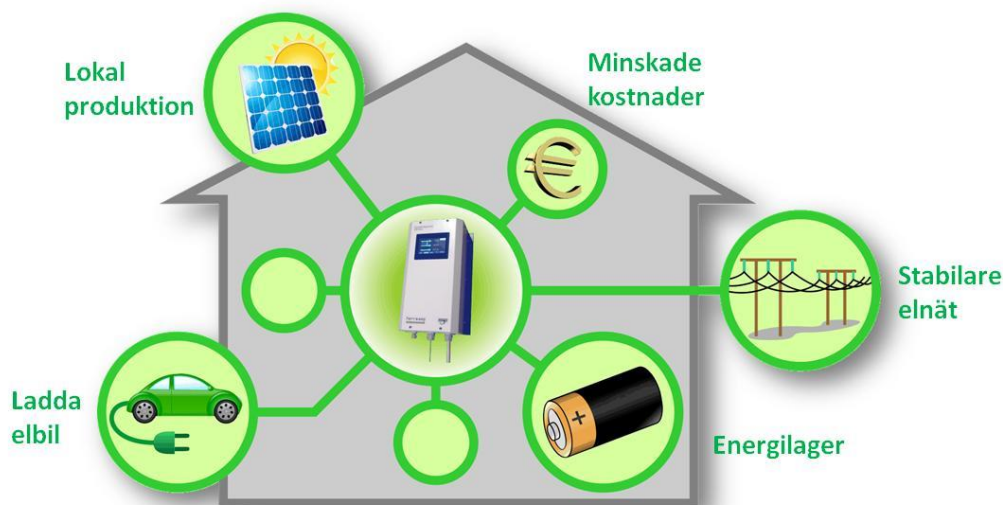
Fig. 3 – Energihuben styr energiflödet mellan solceller, energilager, lokal förbrukning och elnät. Källa: Sammanfattning av projektet om energilagring hos FEAB
