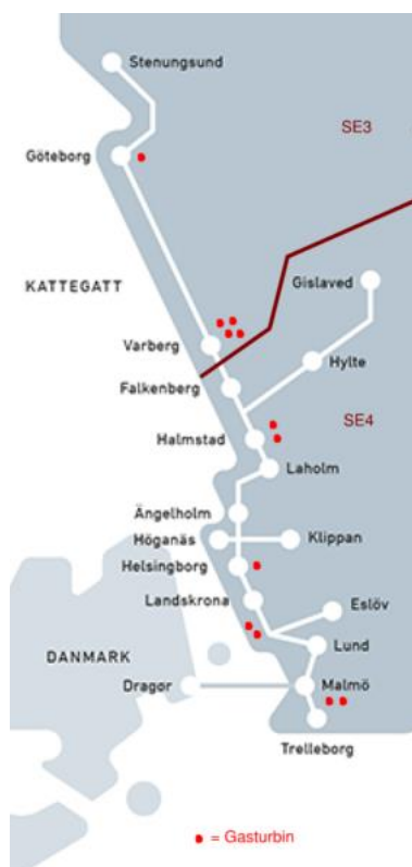
Figur 5: Närliggande gasturbiner (i den snabba aktiva störningsreserven) till stamnätet för gas samt gränsen mellan SE3 och SE4. Källa: Sammanställd av Sweco
